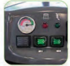
دارای بارومتر یا فشارسنج، جهت نمایش و اعلام فشار وارده بر موتور
